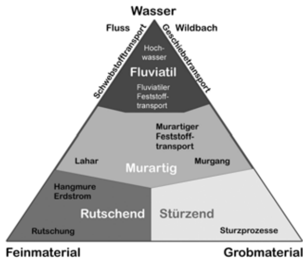
Abb. 2: Übersicht über die Systematik der Verlagerungsprozesse in Wildbacheinzugsgebieten; aus [1] Fig. 2: Systematic overview of displacement processes in torrents
