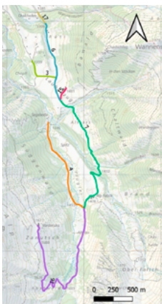
Abb. 2: Strassenabschnittsbildung mit zugewiesener ID. Der mittlere Strassenzug ist in verschiedene Abschnitte unterteilt, da es einen Belagswechsel gibt (Abschnitt 6: Hartbelag, Abschnitte 7 und 17: Naturstrassenbelag).
