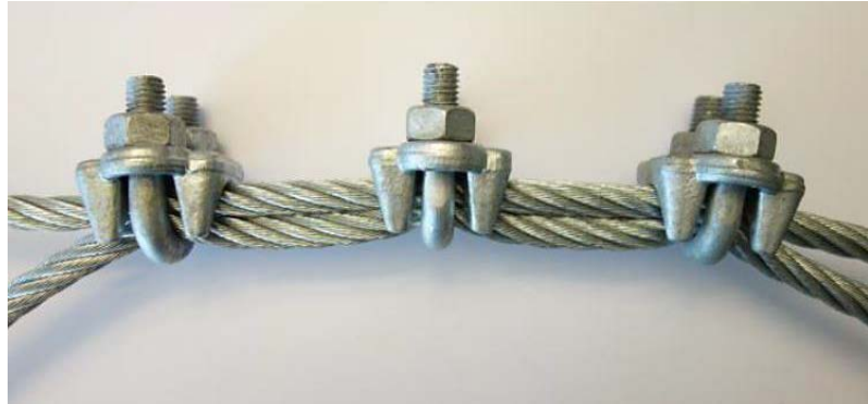
Abbildung 2: Klemmung Drahtseile nach Montage mit vorgeschriebenem Anziehdrehmoment gemäss FF-C-450 Typ 1 Klasse 1 aus Geobrug Systemhandbuch 250-N-FO / 07.
