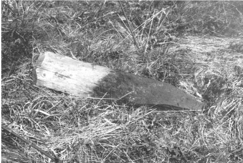
Abb. 80 Der hier ausgegrabene Pfahl zeigt sehr deutlich das falsche Einschlagverhältnis. Der im Boden steckende Teil entspricht lediglich etwa der Hälfte der Gesamtlänge anstatt zwei Dritteln (Tristelderen, OW).
