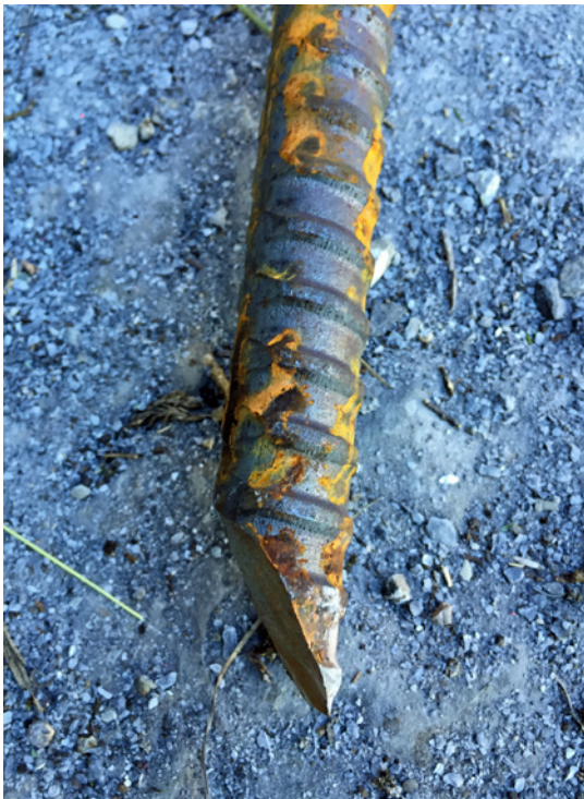
Abb. 4. Schräg angeschnittene Ankerstange eines Klebeankers (Foto IMPULS AG).
