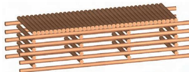
Figure 1 : Platelage avec rondins entiers disposés côte à côte
