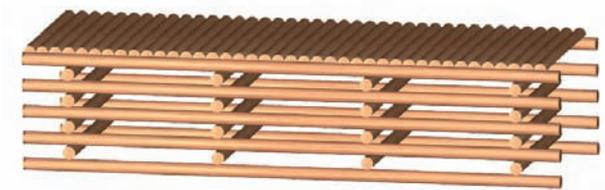
Figure 2 : Platelage avec rondins refendus sur la longueur disposés dans le même sens
