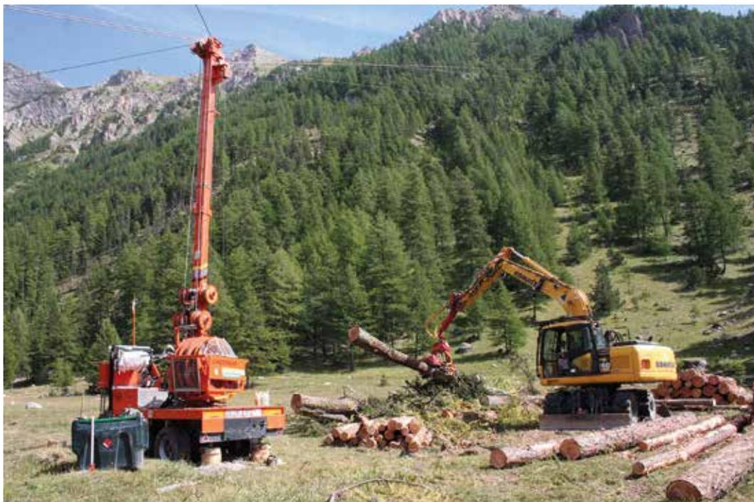
**Mât monté sur remorque avec moteur autonome**
