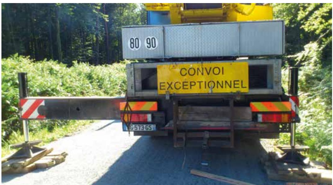
*Dispositifs sous les pattes stabilisatrices du camion pour protéger la chaussée du poinçonnement*
