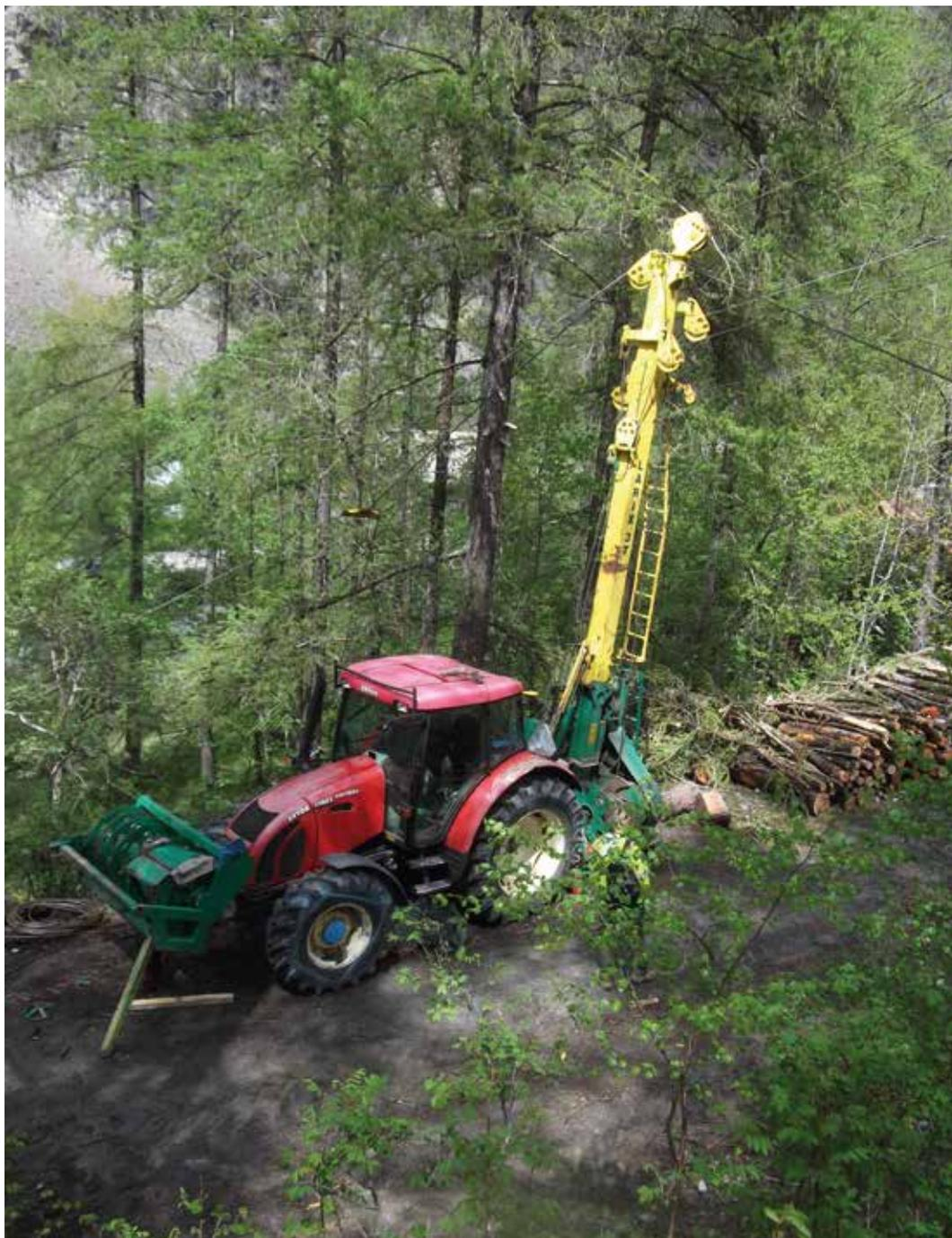
*Mât monté sur tracteur avec treuil relié à la prise de force du tracteur*
