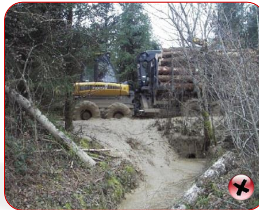
Accumulation de sédiments en fond de vallée. Contraintes d'exploitation.
