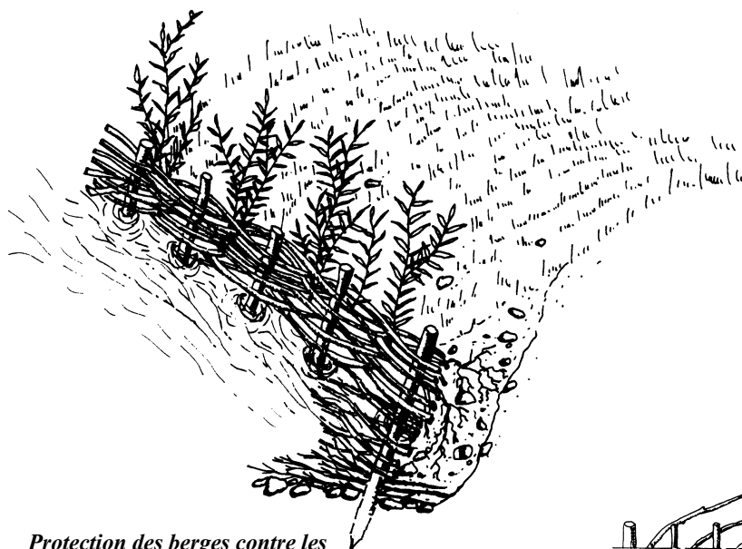
Protection des berges contre les affouillements par l'utilisation de tressages et de lits de plançons
