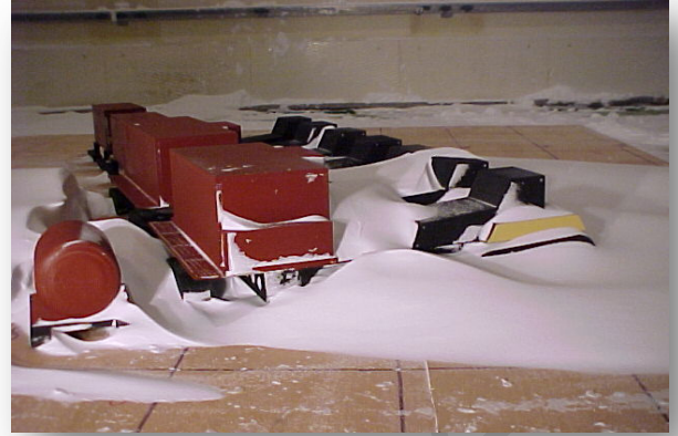
Cliché 25. Optimisation de l'agencement des convoies pour la construction de Concordia dans la soufflerie climatique du CSTB de Nantes
