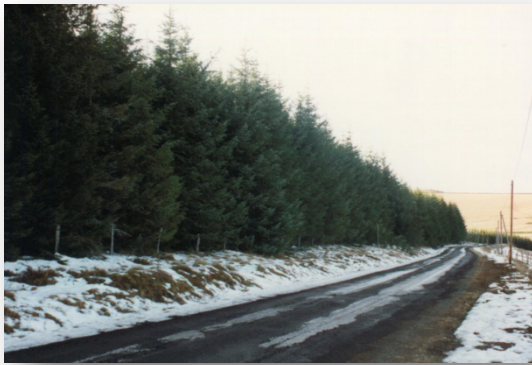
Cliché 118. Verglas persistant à cause de l'ombre portée d'une bande boisée (F. Naaim/Irstea)
