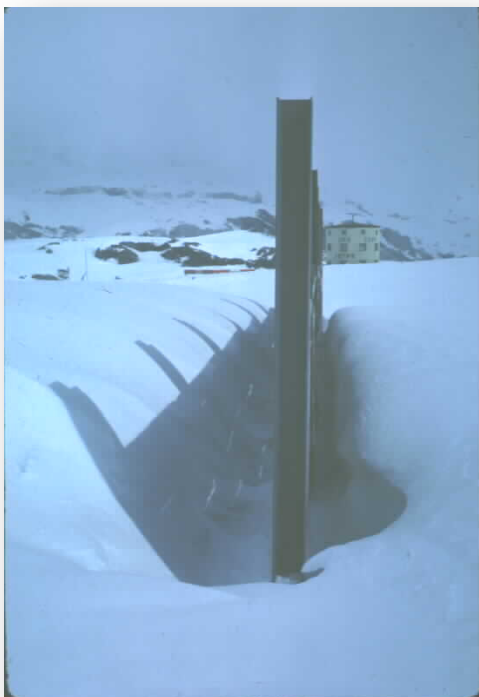
Cliché 38. Congère générée par une barrière poreuse avec garde au sol (J.M. Taillandier/Irstea)
