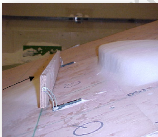
Cliché 39. Modélisation physique du comportement d'une barrière à neige pleine avec garde au sol et de hauteur H sur terrain pentu avec de la neige de canon dans la soufflerie du CSTB
