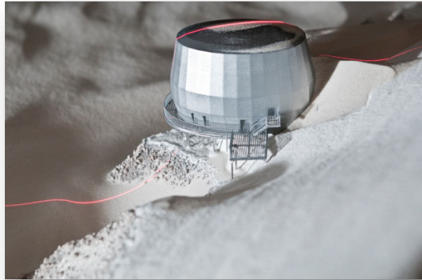
Cliché 22. Modélisation en soufflerie (Irstea) de la formation d'accumulation au droit du refuge du Goûter – Hubert Raguet
