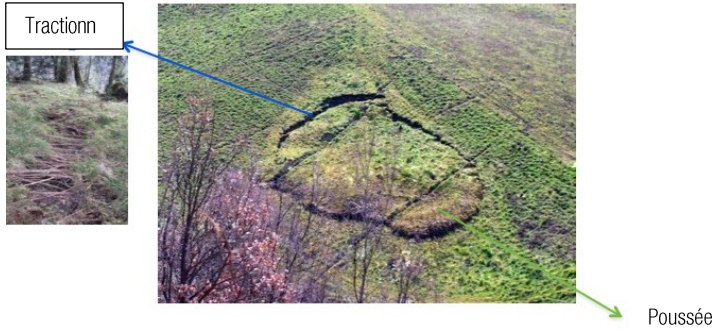
Illustration 10 Glissement superficiel avec zone de traction et zone de compression.
