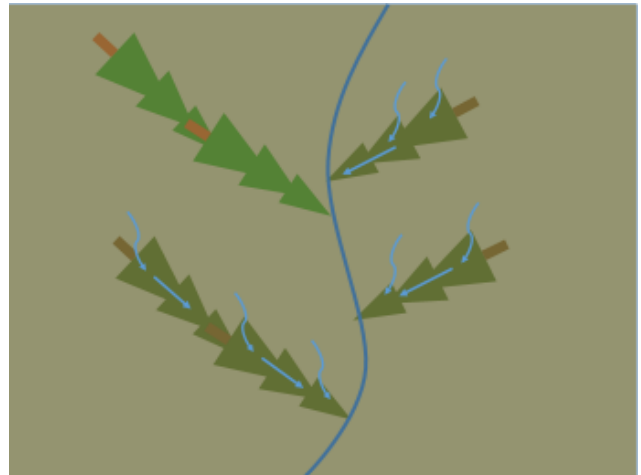
Illustration 30 mise en place de résineux complet qui ménagent un chemin pour l'eau tout en maintenant les terres alentour. (fobatec).
