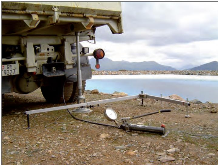
Foto: Plattendruckversuch mit LKW als Gegengewicht
