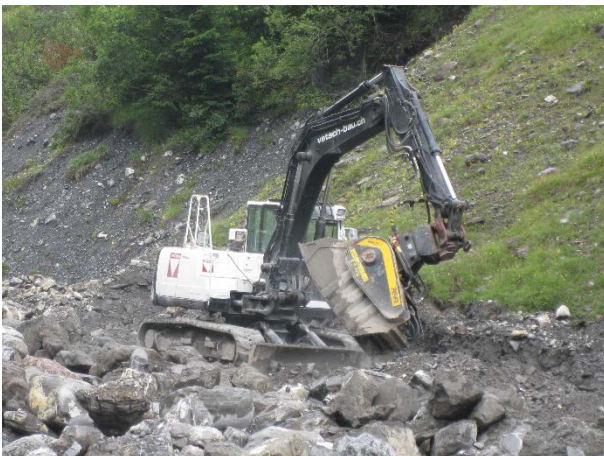
Abbildung 30 Ein Kübelbrecher, der bei sehr entlegenen und kleinen Baustellen sinnvoll sein kann (bap Ing.).
