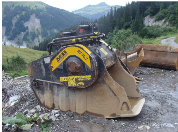
Abbildung 30 Ein Kübelbrecher, der bei sehr entlegenen und kleinen Baustellen sinnvoll sein kann (bap Ing.).
