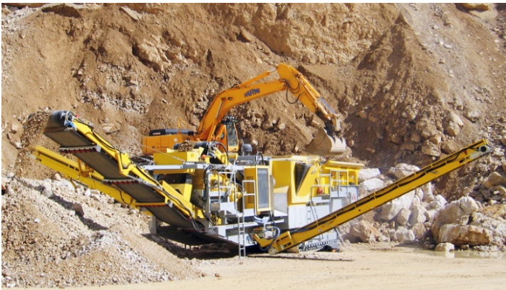
Abbildung 26 Raupenmobiler Prallbrecher mit mehreren Ausgabebändern für die verschiedenen Gesteinskörnungen (GIPO AG).
