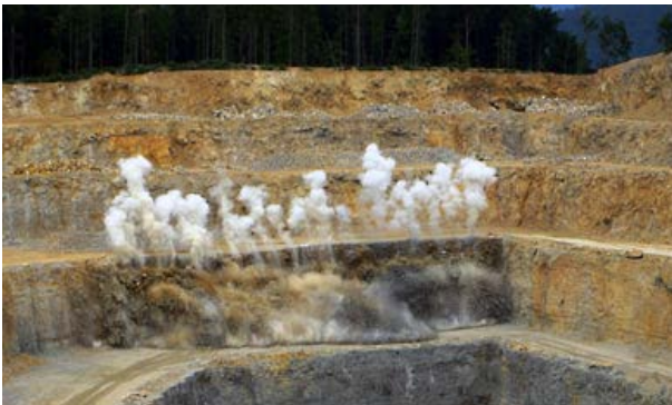
Abbildung 21 Abbau durch sprengen (links) und Zerkleinerung des Materials mittels Brecher (rechts)
