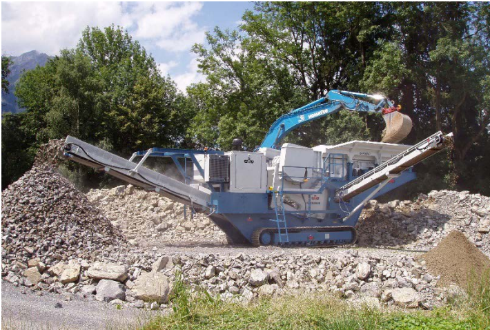
Abbildung 24 Raupenmobiler Backenbrecher mit Vorsieb, das die Abscheidung von Feinanteil vor dem Brechvorgang ermöglicht (GIPO AG).
