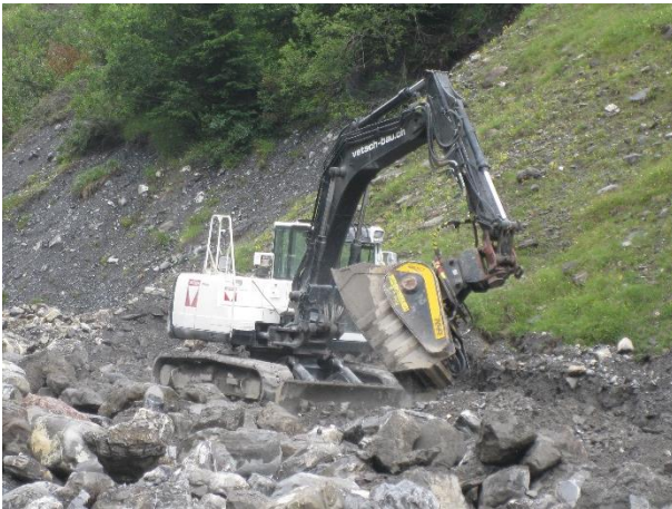
Illustration 28 Un godet broyeur peut rendre des services sur les chantiers éloignés ou de peu d'importance. (bap Ing.).
