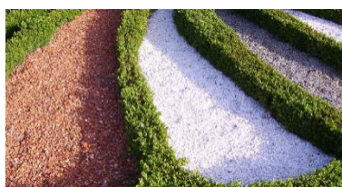
Illustration 65 RC-Granulat de tuiles dans l'aménagement extérieur
