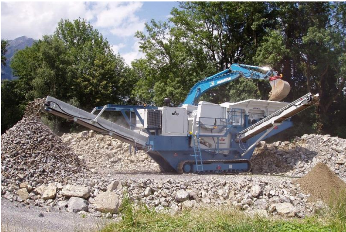
Illustration 15 Concasseuse à mâchoires mobile sur chenilles avec un tamis en tête pour éliminer la fraction la plus fine (GIPO AG).
