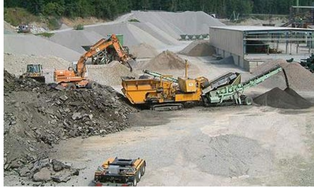
Illustration 20 Exploitation de roches compactes par tir de mine (gauche) et réduction du matériau par concassage (droite)
