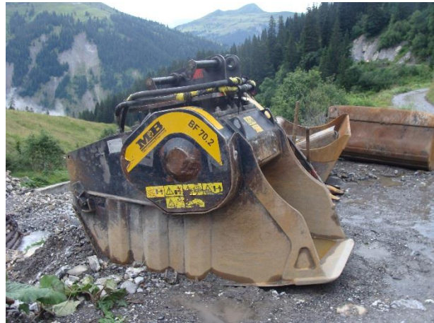
Illustration 28 Un godet broyeur peut rendre des services sur les chantiers éloignés ou de peu d'importance. (bap Ing.).
