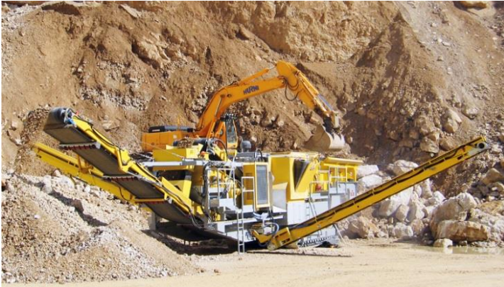
Illustration 24 concasseuse à impacts sur chenilles avec triage de différentes fraction (GIPO AG).
