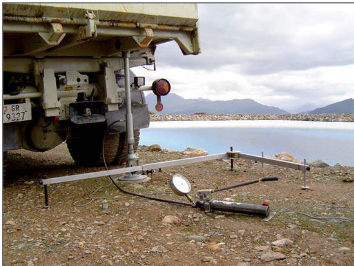
Essai ME à la plaque, le PL est utilisé comme contre-poids
