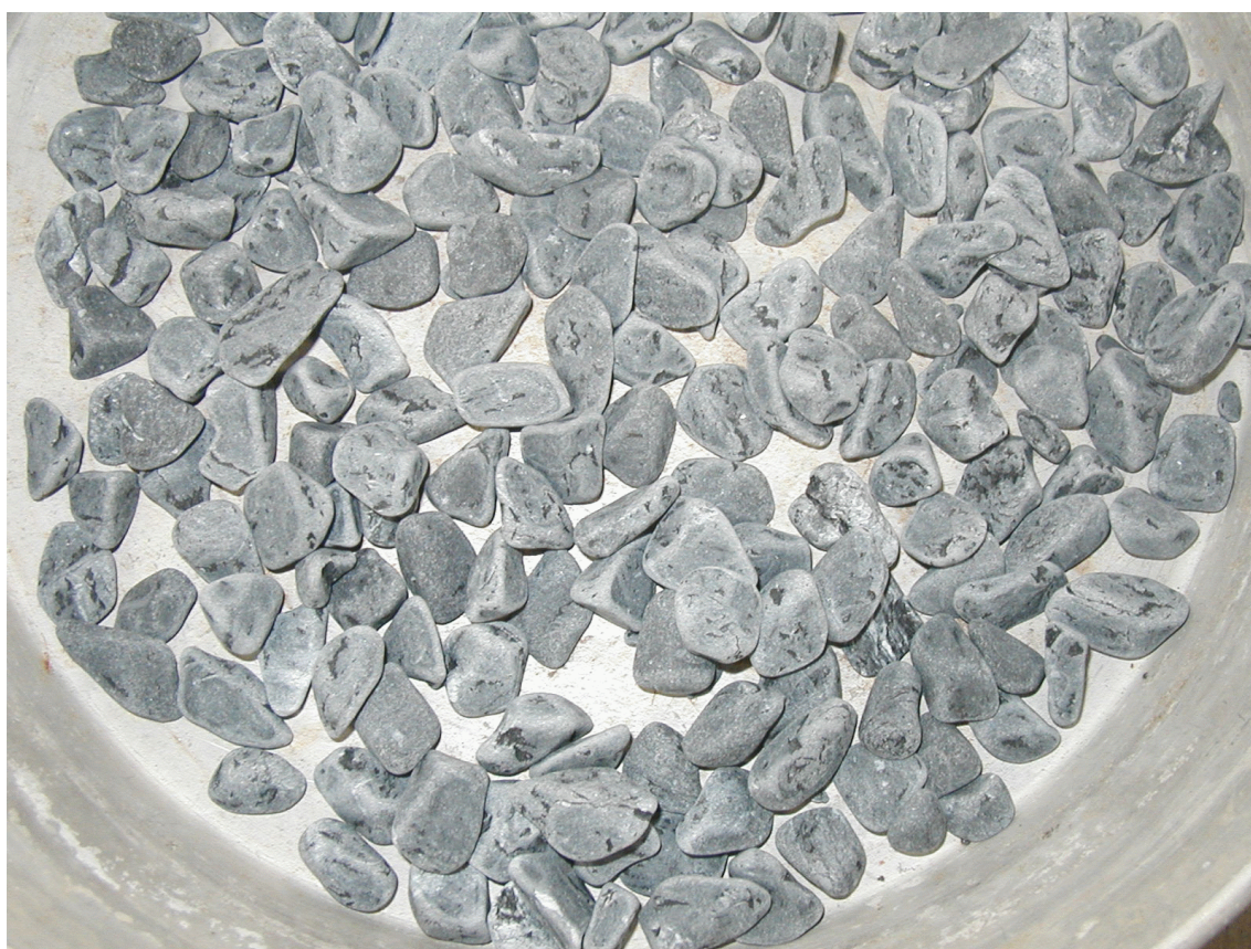
Micro Deval : Échantillon après séchage et écrêtage à 1,6 mm (source : CETE)
