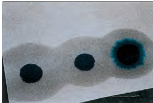
Auréole bleue apparaissant à la périphérie de la tache indiquant la fin de l'adsorption du bleu sur le sol.
