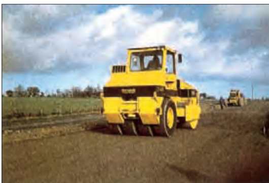
Un compacteur mixte pouvant être considéré comme la somme d'un compacteur vibrant monocylindre de la classe V3 et d'un rouleau à pneus de la classe P1.
