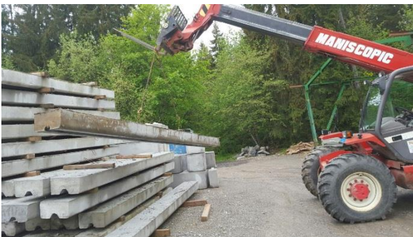
Illustration 7: Die vorbereiteten Querabschläge lassen sich durch die Anhängervorrichtung schonend transportieren
