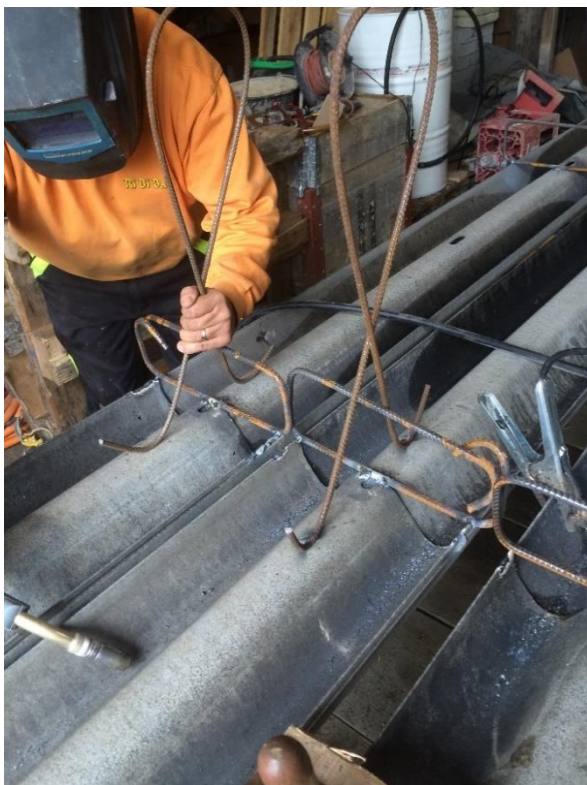
Illustration 3 : Comme les étriers, le dispositif de levage pour le transport est soudé aux glissières de sécurité.
