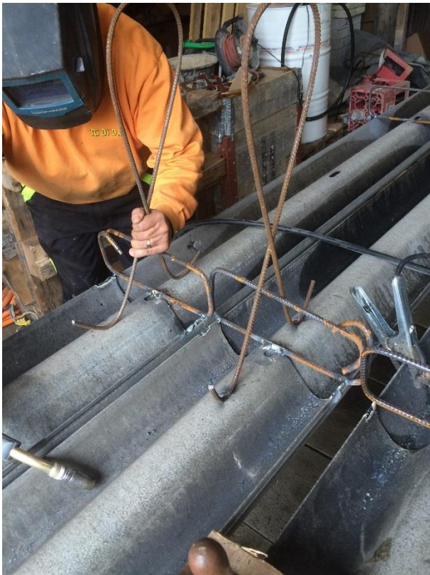
Abbildung 3: Gleich wie die Bügel werden die Anhängenvorrichtungen für den Transport an die Leitplanken angeschweisst
