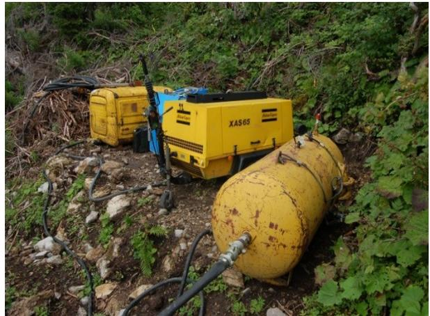
Abb. 14: Auf dem vorbereiteten Installationsplatz werden die Maschinen und Treibstofftanks positioniert
