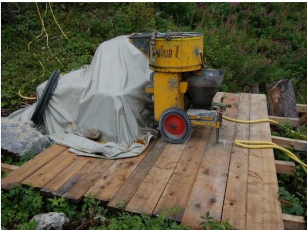
Abb. 15: Für die Mörtelanlage wurde eigens ein Holzpodest als Installationsplatz erstellt
