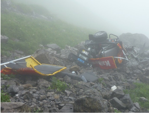
Abbildung 13: Naturgefahren auf der Gebirgsbaustelle; Durch ein Steinschlagereignis zerstörter Kompressor (AFJ 2014)
