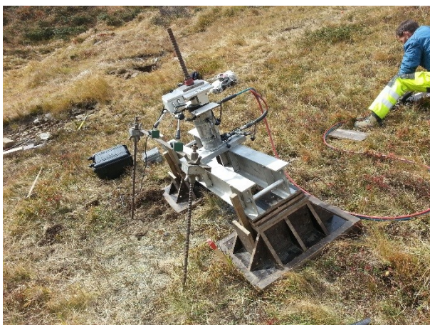
Abbildung 17: Versuchsanordnung für den Ausziehversuch am VA 2 zur Ermittlung des äusseren Tragwiderstandes
