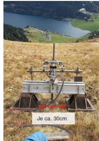
Abb.: Links: Schema Ankerzugvorrichtung für Ausziehversuche und Ankerproben; rechts: Versuchsanordnung am Dorfberg (Quelle: tur GmbH 2014)
