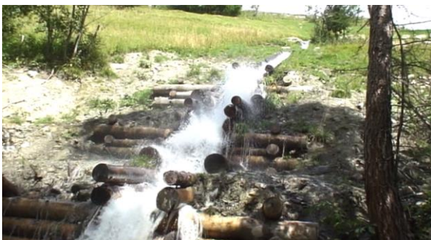
Abb. 11: Testlauf mit 130 l/s über Holzkästen.
