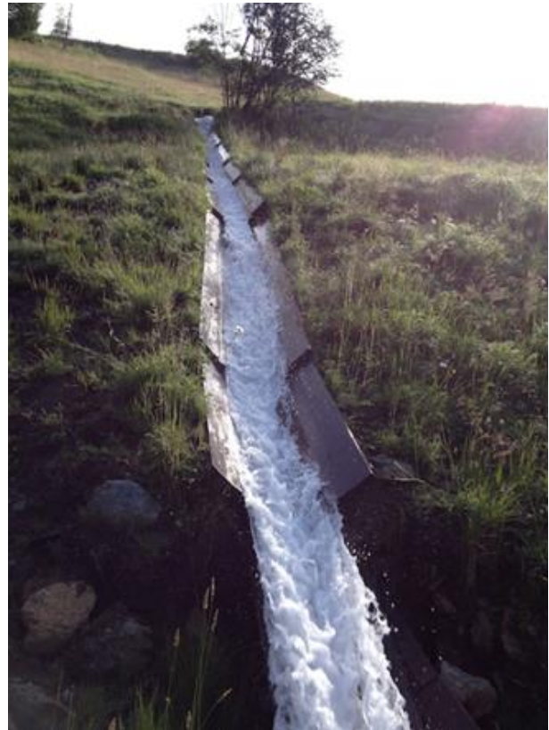
Abb. 12 Testlauf mit 130 l/s über V-Kanäle.
