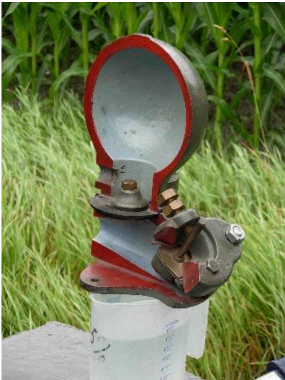
Abbildung 8: Aufgeschnittenes Anschauungsmodell des hydraulischen Widders. Gut sichtbar sind die Druckkammer und das Schlagventil.
