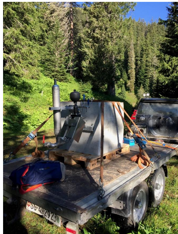
Abbildung 13: Anlieferung des hydraulischen Widders mittels PKW-Anhänger.
