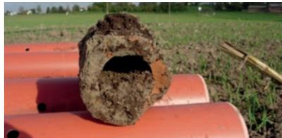
*Solch eingewachsene und verstopfte Rohre führen zu Rückstau und Schäden.*
