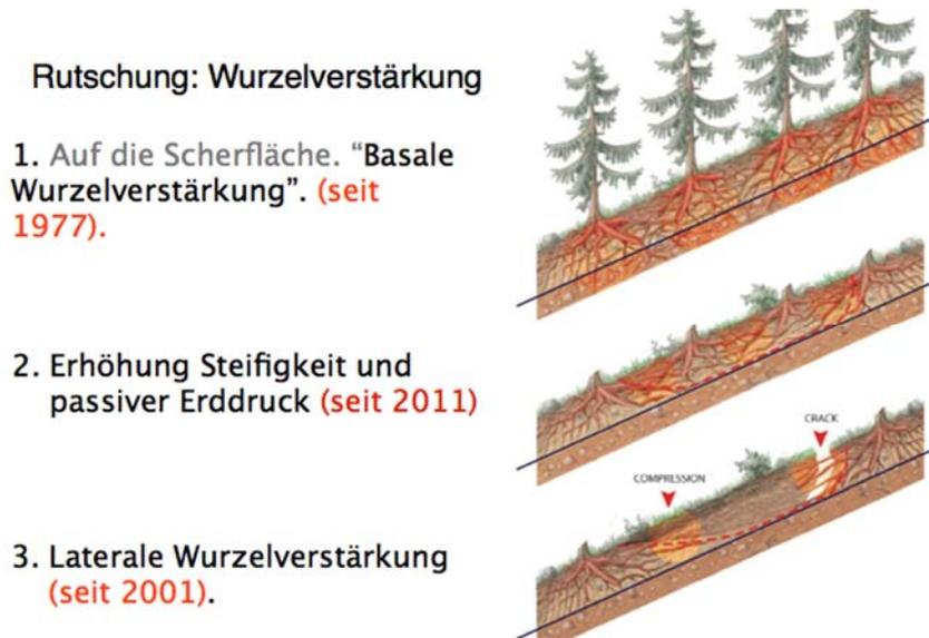
Abbildung 69 Darstellung der drei möglichen Mechanismen durch welche die Wurzelverstärkung stabilisierend wirken. Modifiziert nach Giadrossich et al. (2014).
