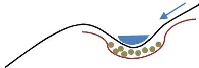
Abbildung 33 Eine mit Bentonitmatte abgedichtete und mit Spreitlage geschützte Grabensohle.
