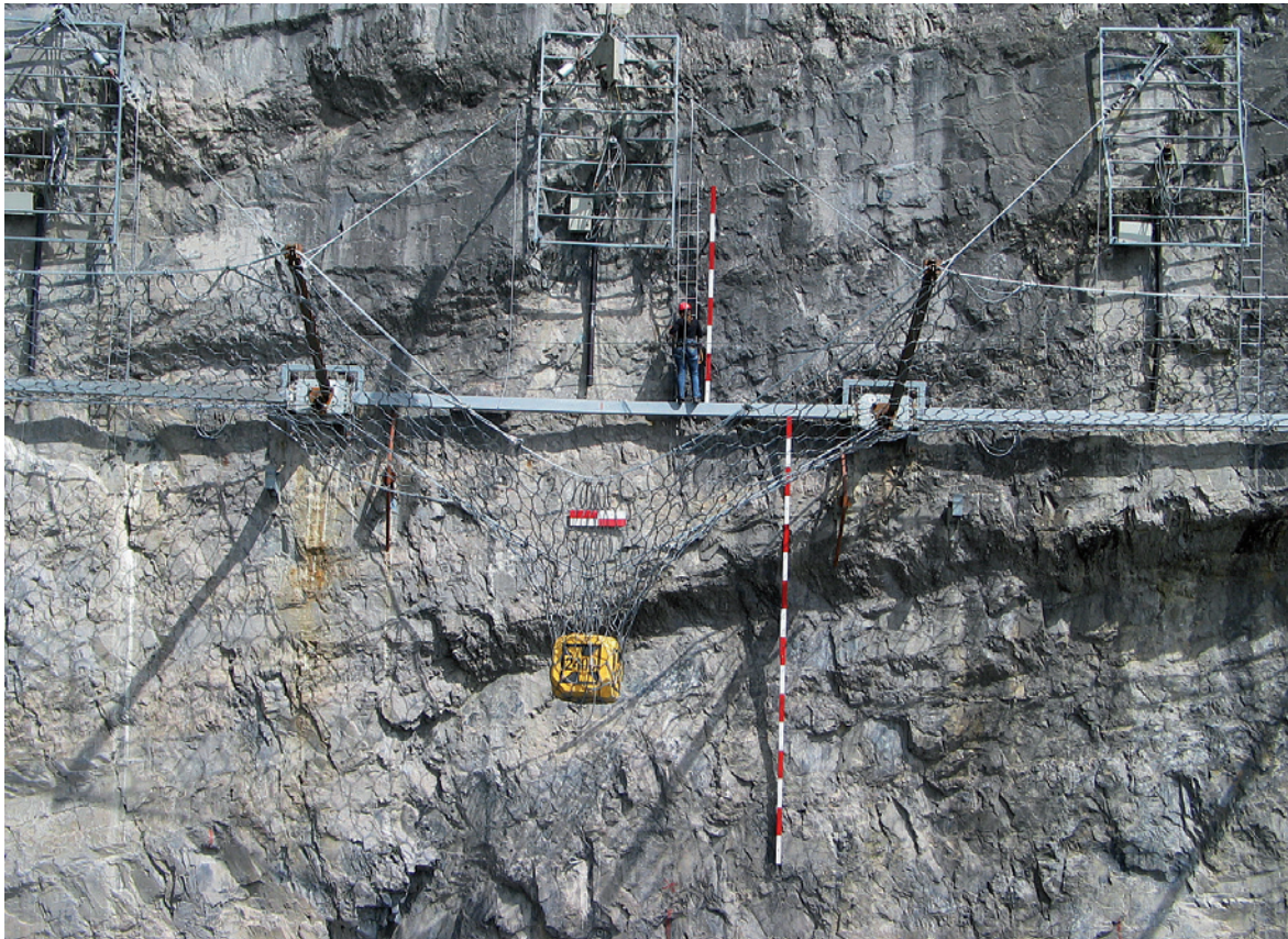
Abb. 3-21: Ein Wurfkörper mit einer Masse von 2400 kg liegt nach dem Abbremsvorgang im Schutznetz (Versuchsanlage Lochezen, Walenstadt SG).
