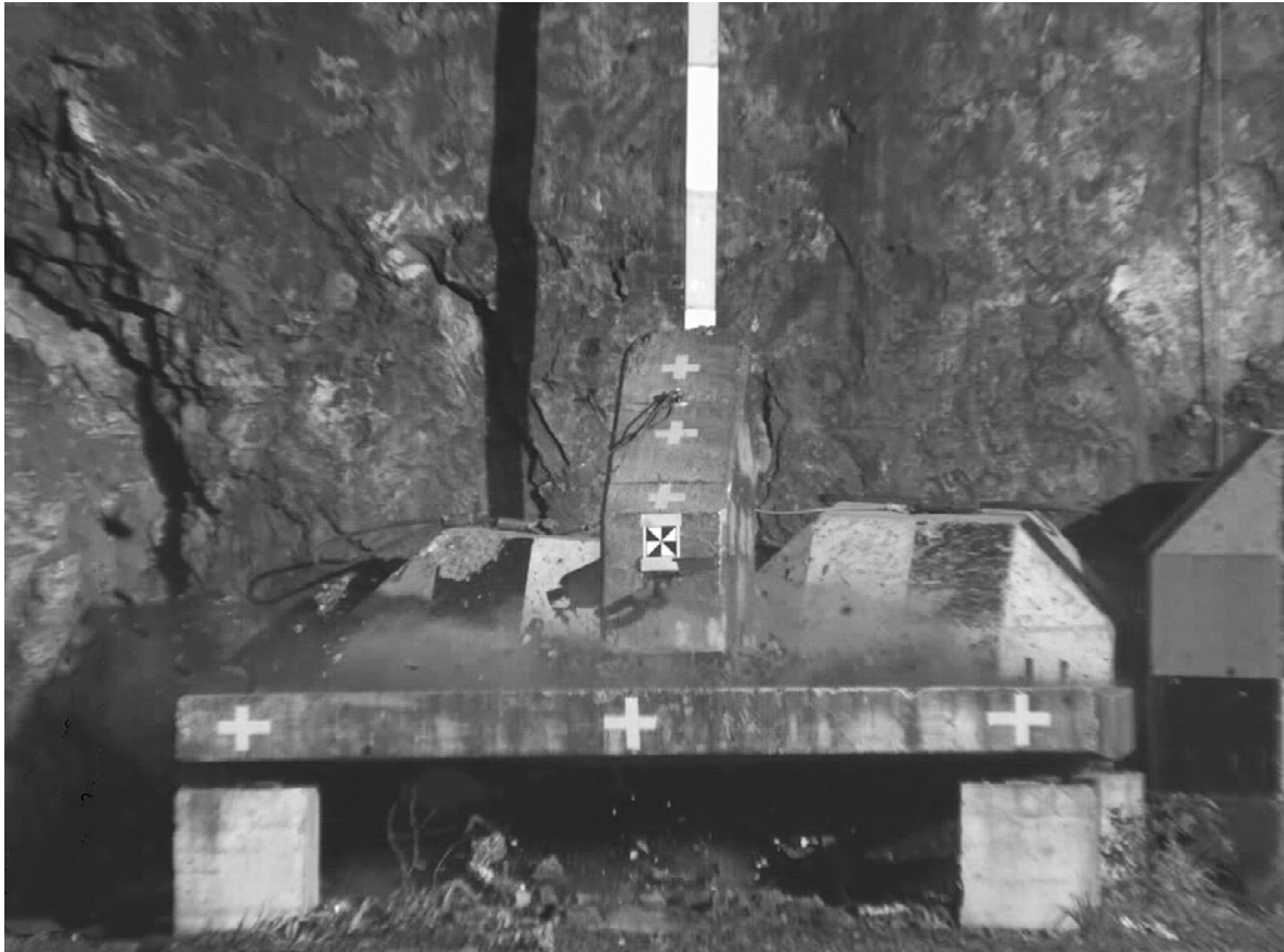
Abb. 5-30: Infolge Aufprall des Wurfkörpers wurde die Betonplatte nach 220 ms um 10 cm angehoben (Versuchsanlage Lochezen, Walenstadt SG).
