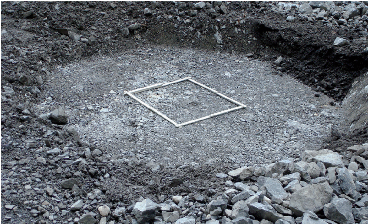
Abb. 5-15: Der mit einem 8000 kg schweren Wurfkörper verdichtete Einschlagkrater (Fallhöhe 15 m) diente als Basis für einen Versuch mit dem 800 kg schweren Wurfkörper.
