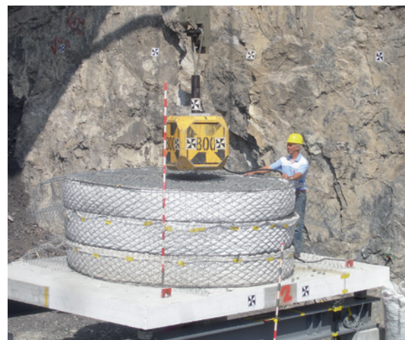
Abb. 5-22: Betonplatten mit Schutzschichten aus Kies (links) und Misapor (rechts) (Versuchsanlage Lochezen, Walenstadt).
