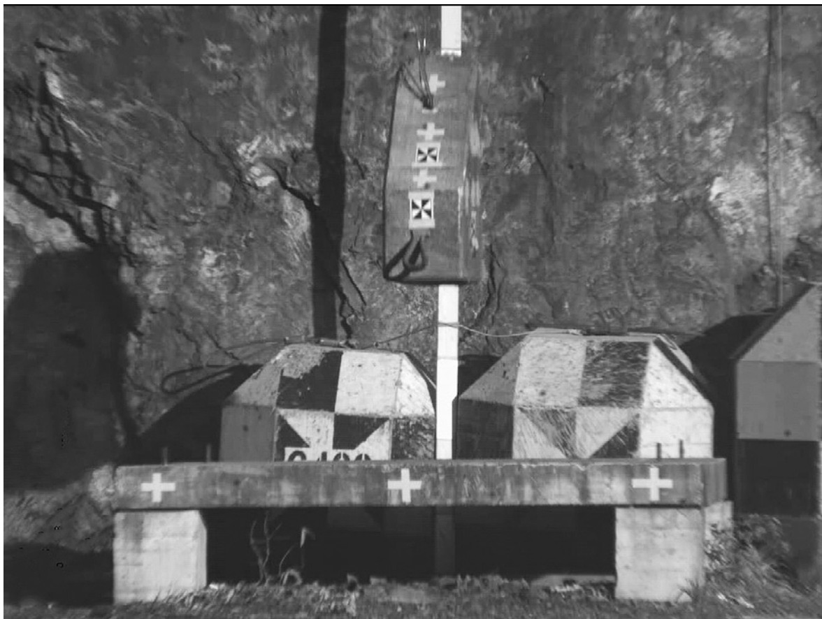
Abb. 5-26: Wurfkörper mit einem Gewicht von 1080 kg und einer Geschwindigkeit von 23,8 m/s kurz vor dem Aufschlag auf eine 25 cm starke Betonplatte (Versuchsanlage Lochezen, Walenstadt SG).
