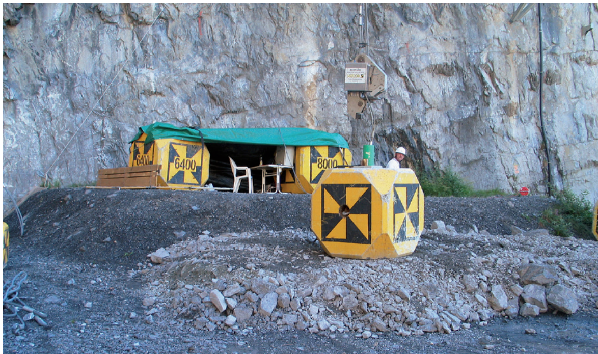
Abb. 5-1: Wurfkörper (4000 kg) kurz vor dem Anheben für einen Versuch auf geschütteten Boden mit einer Dicke von 0,5 m. Im Hintergrund eine Bodenschicht mit einer Dicke von 1,3 m (Versuchsanlage Lochezen, Walenstadt SG).
