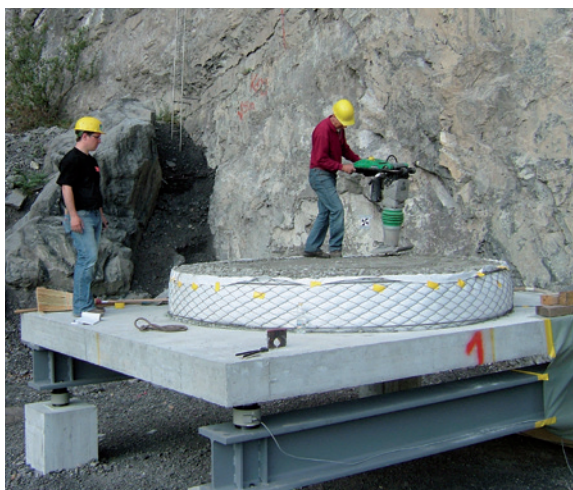
Abb. 5-22: Betonplatten mit Schutzschichten aus Kies (links) und Misapor (rechts) (Versuchsanlage Lochezen, Walenstadt).
