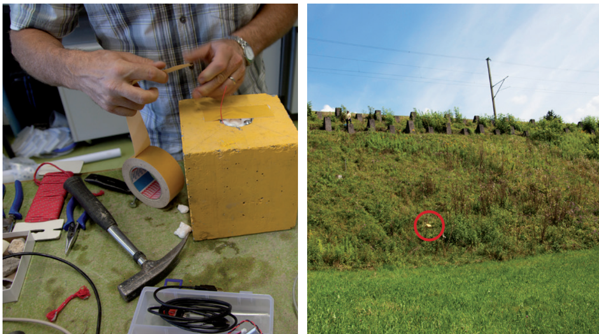
Abb. 4-27: Betonwürfel mit montiertem Sensor und Feldversuch an Böschung (Landikon, Birmensdorf ZH).
