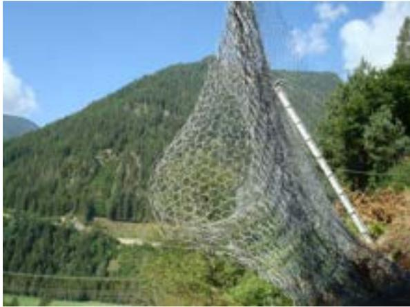
Deformiertes Steinschlagnetz ©WLV Geologie
