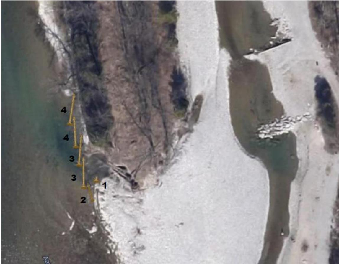
Abbildung 3: Im Zuge des Projekts realisierte Tothholzelemente in der Aare (Foto: Kästli Bau AG)
