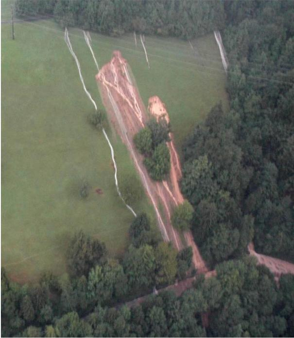
Abbildung 2: Rufe Nr. 412.03, flachgründige Hangmure mit Gleitfläche auf Fels
